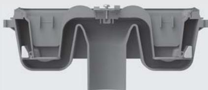
До тех пор пока сифоном не протекает вода, заслонки находятся в закрытом положении и препятствуют проникновению запаха из канализации, при высыхании мокрого гидрозатвора.
